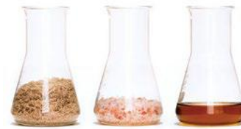
ca. 60% Reishülsen + ca. 22% Steinsalz + ca. 18% Mineralöl = Resysta
